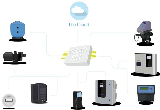
El control de la seva piscina des de qualsevol lloc i quan vostè ho desitgi, ja és possible mitjançant el seu ordinador o telèfon mòbil. Entre els diferents paràmetres que pot controlar hi ha: la temperatura de l'aigua, el nivell de clor i pH de l'aigua, la il·luminació, la filtració... Disposarà d'una aplicació on li serà possible regular el funcionament dels components instal·lats a la seva piscina de manera remota en qualsevol moment i lloc.
